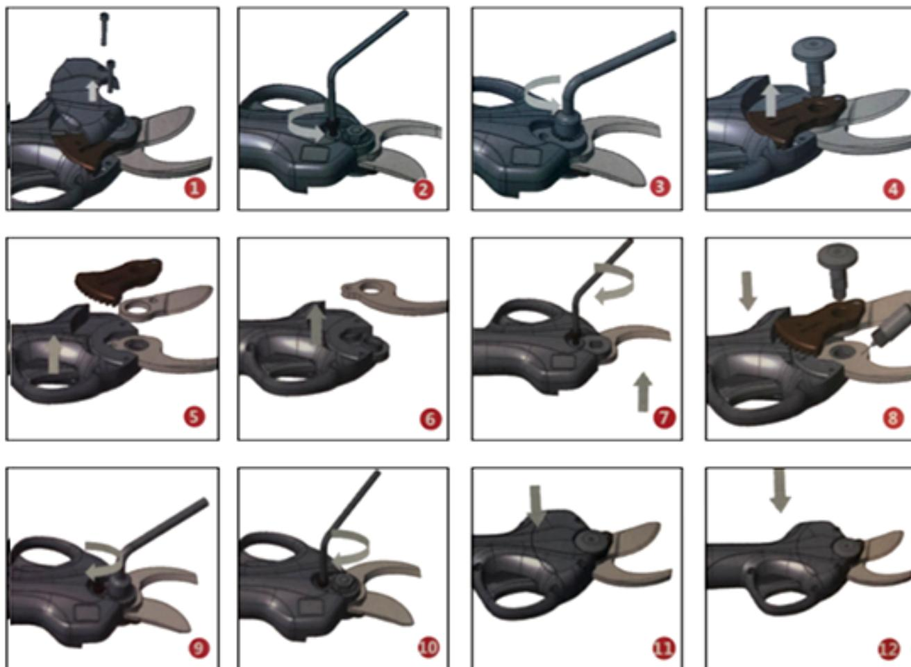
È possibile sostituire le lame fissa e mobile separatamente.
