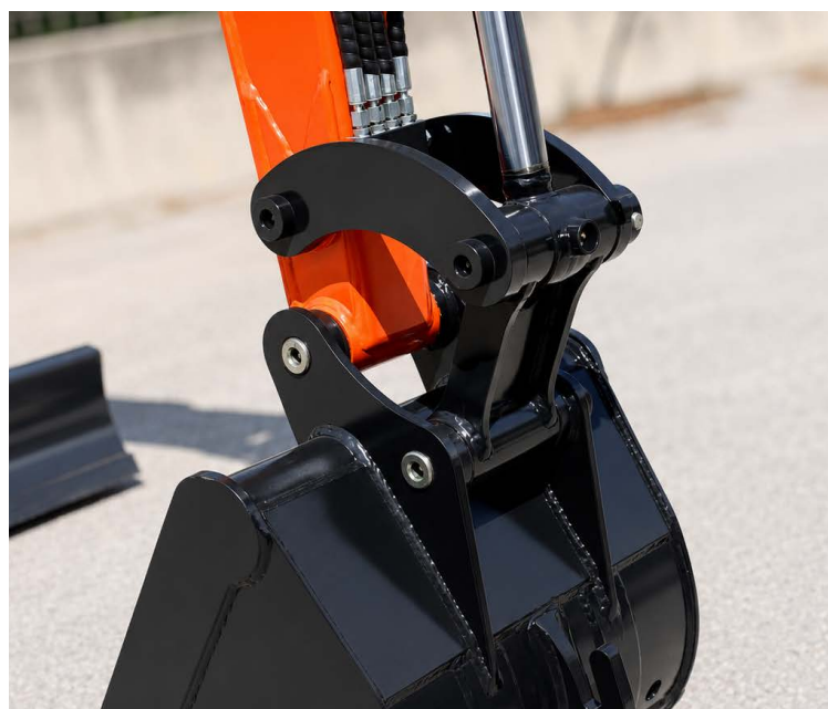
SOSTITUZIONE ACCESSORI CON SISTEMA DI SGANCIO RAPIDO
