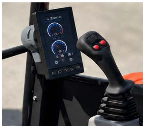
DISPLAY A COLORI con tutte le informazioni della macchina
