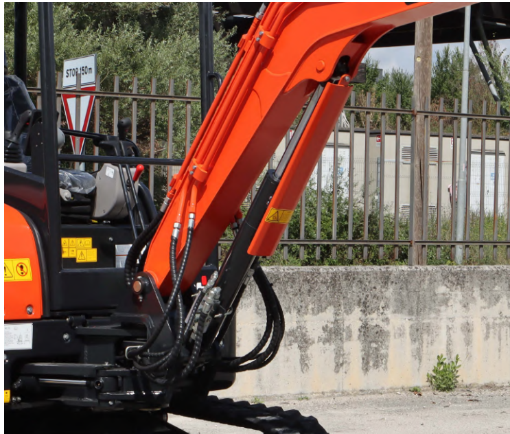
PISTONE PRIMARIO CON PROTEZIONE SAGOMATA
