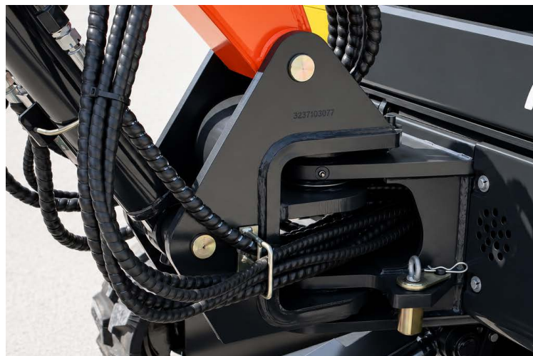
BRANDEGGIO SUPPORTATO DA UN BLOCCO IN GHISA
