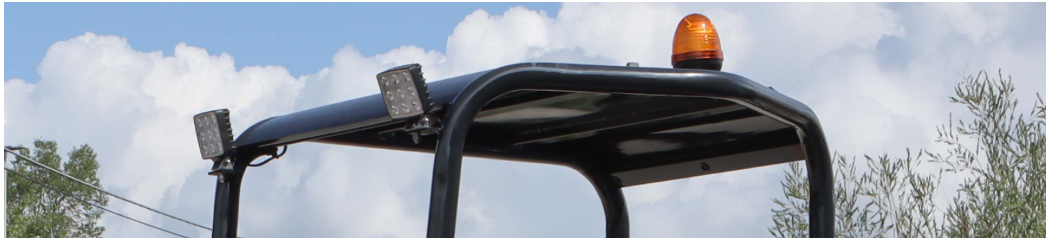
2 FARI LED ORIENTABILI - ROBUSTO ROLL BAR - TETTO IN LAMIERA RINFORZATA
