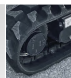
CINGOLI AD ALTA DENSITÀ CON MOTORIDUTTORI
