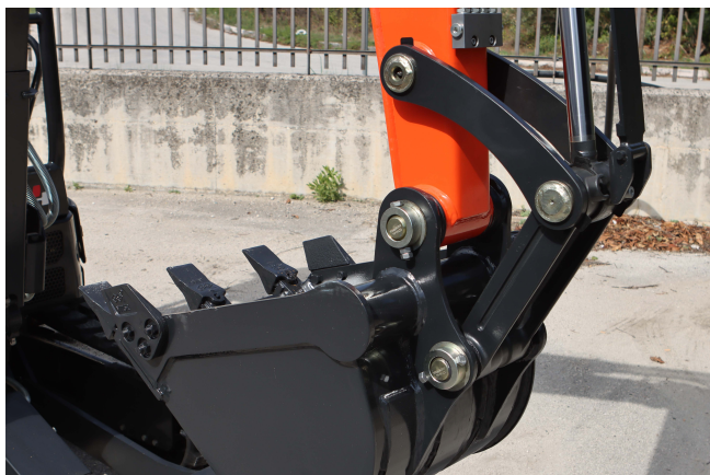
SOSTITUZIONE ACCESSORI CON SISTEMA DI SGANCIO RAPIDO
