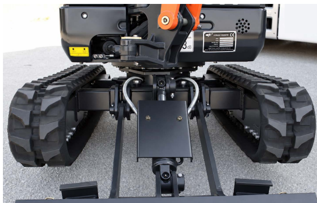
CARRO ALLARGABILE da 1080mm a 1400mm
