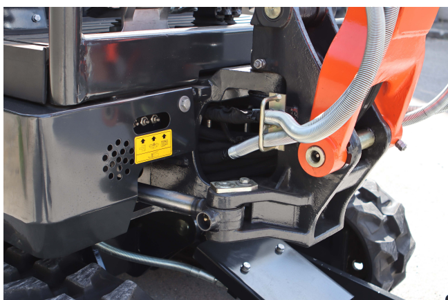
BRANDEGGIO SUPPORTATO DA UN BLOCCO IN GHISA
