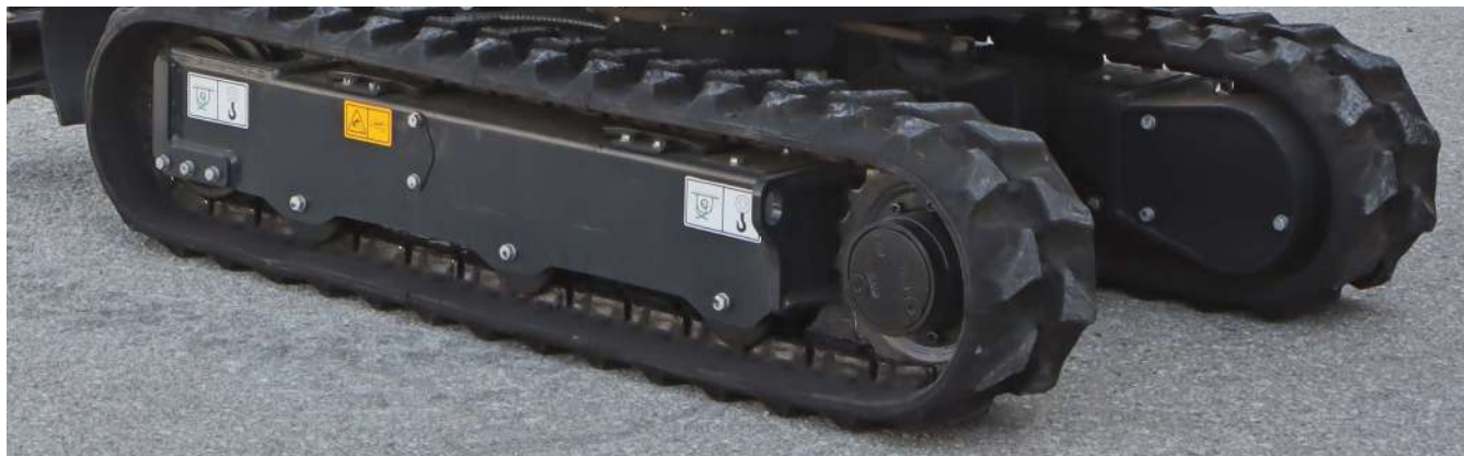
- ROBUSTO SOTTO CARRO CON MOTORIDUTTORI - ALLARGABILE da 990mm a 1240mm
